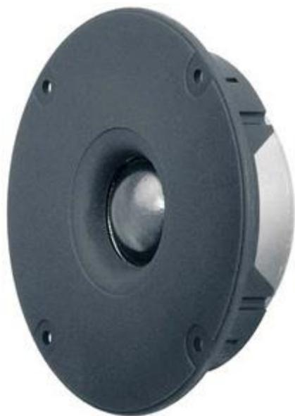
**Magnetisch abgeschirmte 25 mm (1") Gewebekalotte** für den Hochtonbereich ab 3000 Hz. Linearer [Frequenzgang](#) durch spezielle Kalottenbeschichtung und hohe Belastbarkeit durch mit [Ferrofluid](#) gekühlte [Schwingspule](#). Zusammen mit dem abgeschirmten Tiefmittelton-Chassis [SC 13 8 Ohm](#) besonders geeignet für den Einsatz in mittelgroßen 2-Weg-Kombinationen für Surround Centerlautsprecher und Multi-Media-Boxen.
