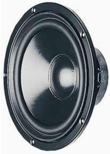
**17 cm (6,5'')** HiFi-Tieftöner mit beschichteter Papiermembran, kräftigem Antrieb und tiefgezogener Polplatte. Spezielle [Schwingspule](#) und elastische Gummisicke für große Hübe.
