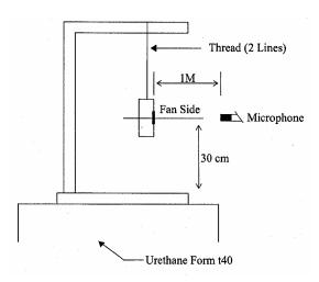
1 METER FROM MICROPHONE TO FAN INTAKE
