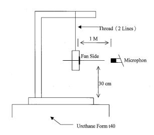
1 METER FROM MICROPHONE TO FAN INTAKE
