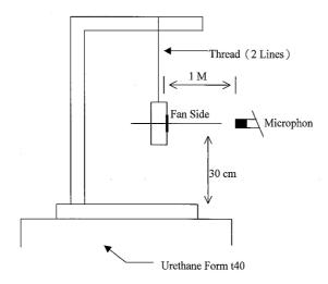
1 METER FROM MICROPHONE TO FAN INTAKE
