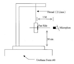
1 METER FROM MICROPHONE TO FAN INTAKE
