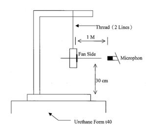
1 METER FROM MICROPHONE TO FAN INTAKE
