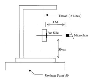
1 METER FROM MICROPHONE TO FAN INTAKE
