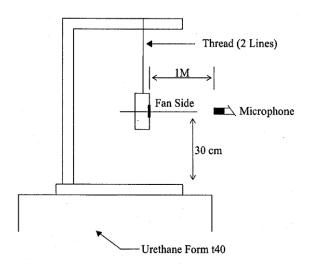
1 METER FROM MICROPHONE TO FAN INTAKE
