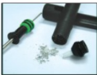
Odpojitelná pumpa se snadno čistí od zbytků pájky
