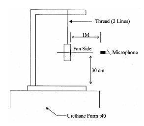
1 METER FROM MICROPHONE TO FAN INTAKE
