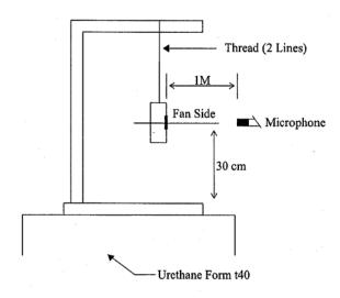
1 METER FROM MICROPHONE TO FAN INTAKE
