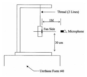
1 METER FROM MICROPHONE TO FAN INTAKE
