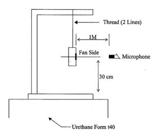
1 METER FROM MICROPHONE TO FAN INTAKE
