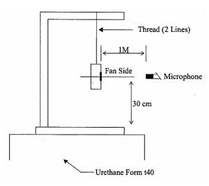
1 METER FROM MICROPHONE TO FAN INTAKE
