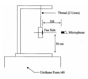
1 METER FROM MICROPHONE TO FAN INTAKE
