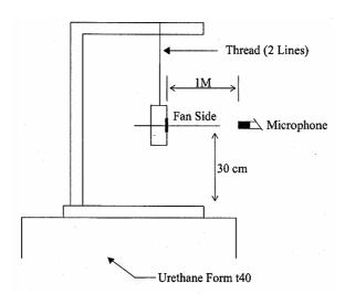
1 METER FROM MICROPHONE TO FAN INTAKE
